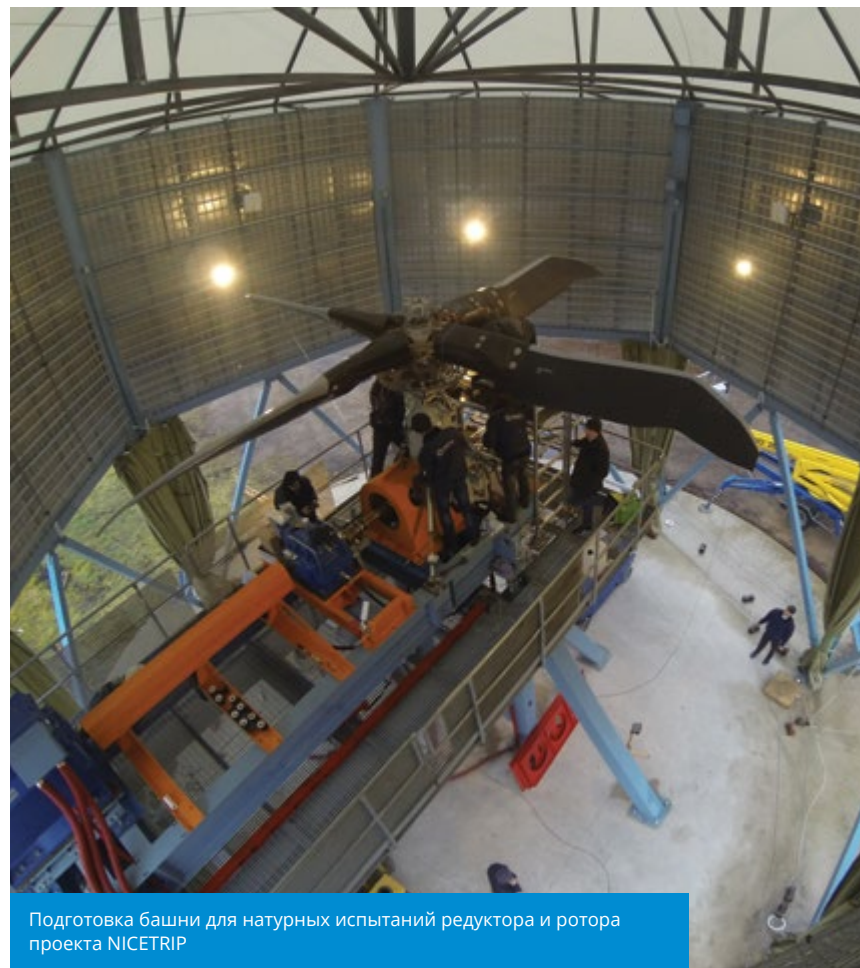
Испытательный стенд для проверки работы редукторов трансмиссий вертолетов и их модификаций
