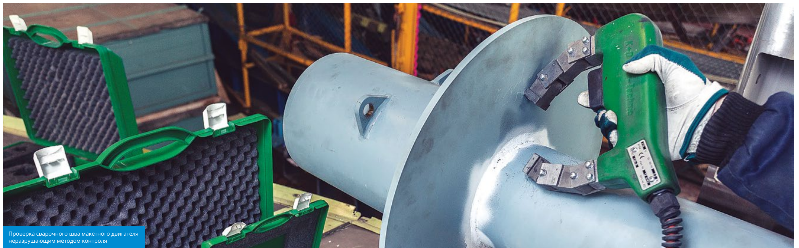
Вихретоковый контроль одного из гермовыводов гермошпангоута самолета
